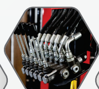
ACCIONAMIENTO DE LOS COMANDOS HIDRÁULICOS POR PALANCAS
